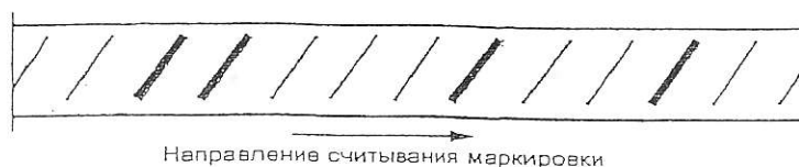
Рисунок 2 – Прокатная маркировка арматурного проката производства ЗАО «БЭМЗ» (номер предприятия – 32).
